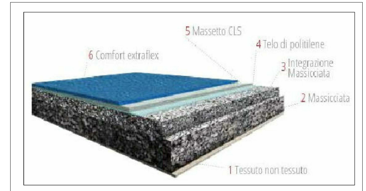
PAVIMENTAZIONE DEL CAMPO POLIVALENTE RAPP. 1:10
